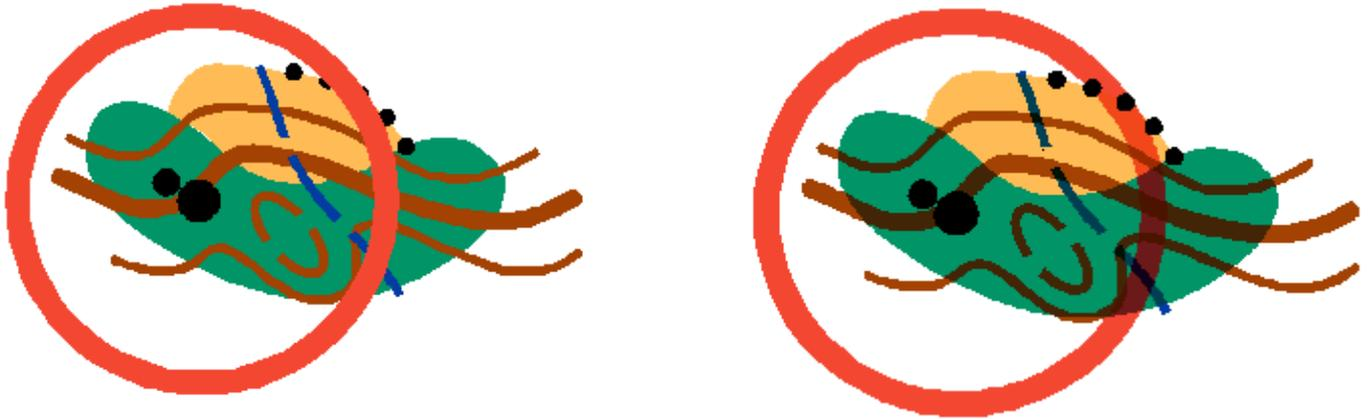
*Illustration: Des courbes de niveau en végétation dense imprimées en 4 couleurs. Effet de surimpression dans l'illustration de droite.*
